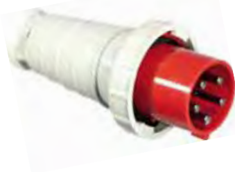
MESV125 Cable mount plug: 125A 220-380V 240-415V AC (3P+N+G), protection (IP67). Spina volante diritta: 125A 220-380V 240-415V AC (3P+N+T), protezione (IP67).
